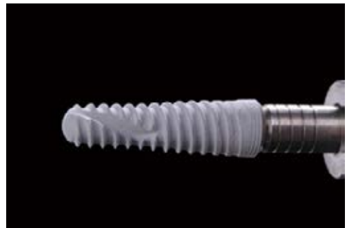
Figura 1a: Impianti dentali a livello osseo utilizzati in questo studio che sono stati inseriti in materiali surrogati dell'osso lasciando 3 mm dell'impianto che si estende dalla superficie dei blocchi ossei.
