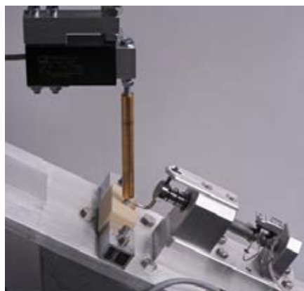
Figura 3: Campione costituito da un impianto inserito in materiale surrogato osseo posizionato in una macchina di prova universale con un angolo di 30° rispetto all'asse lungo dell'impianto. Il carico viene applicato attraverso la barra color ottone mentre lo spostamento dell'impianto viene trasferito a un estensimetro posizionato a distanza.
