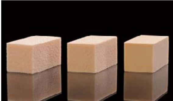
Figura 1b: I materiali surrogati ossei utilizzati in questo studio mostrano una struttura solida e omogenea e densità di 10 pcf, 20 pcf e 30 pcf (da sinistra a destra).
